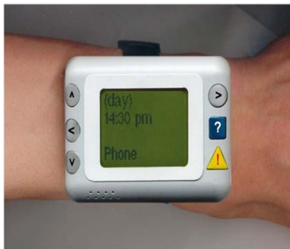
Abbildung 2: SILC Prototyp (2003) mit internen Sensoren aber externer (!) Batterie.
